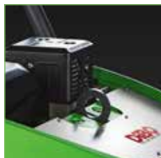
Anneau de levage qui facilite le levage des machines à l'aide d'une grue
