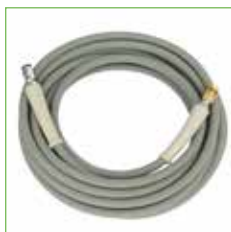
Rallonge tuyau HP avec raccords sur longueurs de 10 m à 25 m pour pressions ≤ 250 bar, ≤ 350 bar et ≤ 500 bar code : 1.208.520.xxx (≤ 250 bar) 1.208.540.xxx (≤ 350 bar) 1.208.560.xxx (≤ 500 bar)
